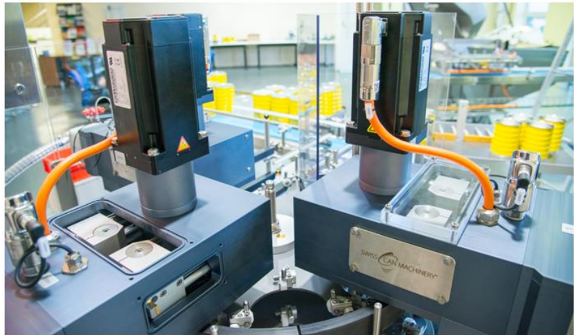
In Bereichen ohne hygienische Relevanz setzen die Schweizer Standardservomotoren der Baureihe AKM ein.
